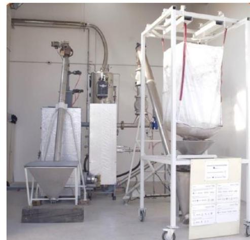
L'impianto prototipale di pirolisi è installato presso l'Università di Parma ed è pronto per ricevere i residui agroindustriali dopo le procedure di estrazione.
