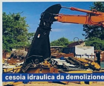
cesoia idraulica da demolizione
