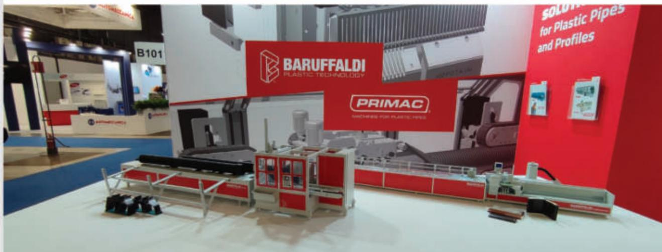
I modelli in scala 1:10 di due macchine dell'azienda Baruffaldi Plastic Technology, realizzati con la consulenza e il supporto del laboratorio LED&PRO di Romagna Tech. I modelli, realizzati in materiale bioplastico tramite stampa 3D, sono stati esposti a Plast 2023, il Salone Internazionale delle Materie Plastiche e della Gomma, tenuto alla Fiera di Milano lo scorso settembre
